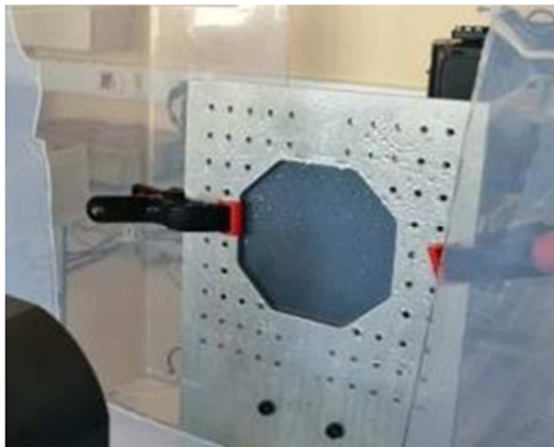
Figure 4 : cellule de test pour la pluie
