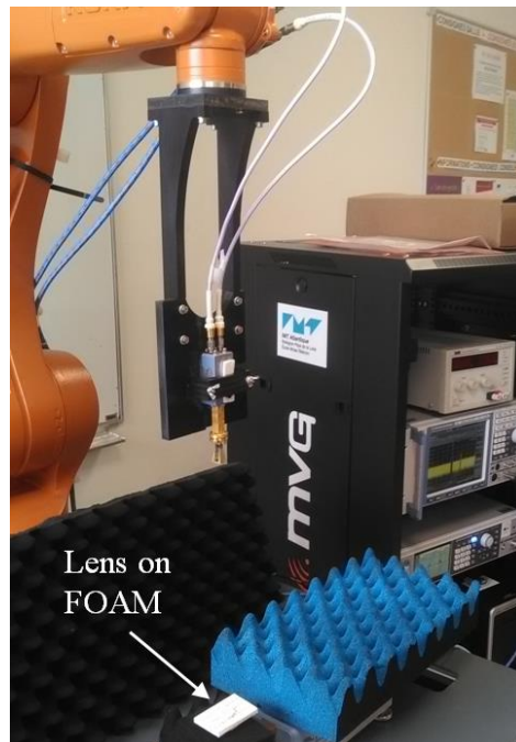
Figure 8. Banc de mesure robotisé
