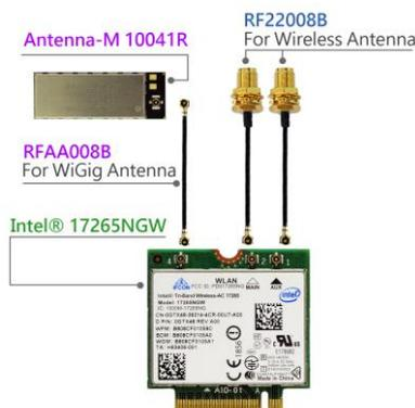
Figure I- 92: Module INTEL 802.11.ad
