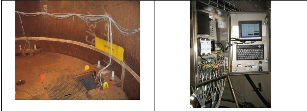
Figure III- 49: Réseau filaire de capteurs de corrosion dans les fondations d'une éolienne offshore
