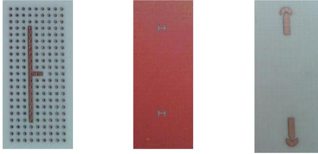
Figure III- 31: Résonateur simple stub en gap waveguide
