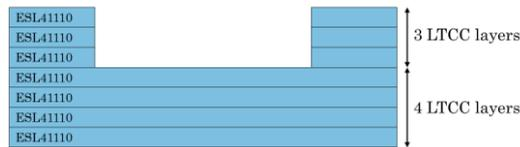
Figure III- 39: Cavités ouvertes en technologie LTCC sur 7 couches
