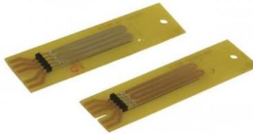
Figure III- 51: Capteur physique de corrosion atmosphérique
